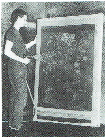
Thomas Gustavsson sprutar bort den vattenlösliga lacken med vatten. Den del som träffades av ljuset är härdad och sitter kvar.
