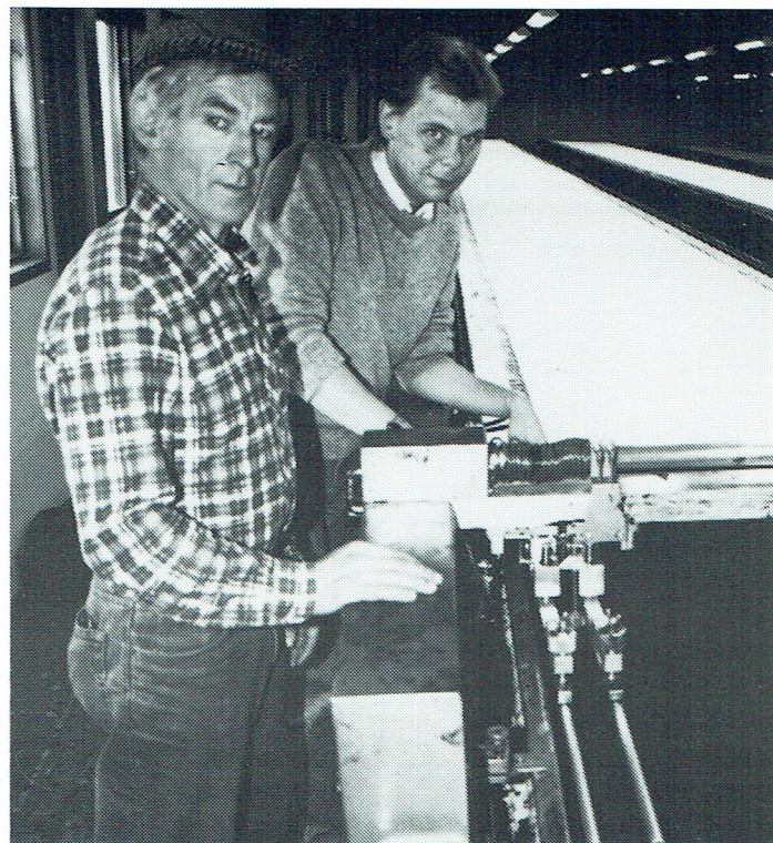
Arne Pettersson och Kaj Kronlöv ställer in vår nya "robot" som sköter handtrycket på de 35 meter långa tryckborden.
